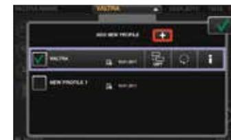
Perfis para operadores e acessórios que podem ser facilmente alterados a partir de qualquer menu do ecrã. Todas as alterações de definição serão guardadas no perfil seleccionado.
